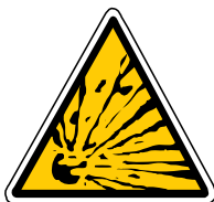
Matières explosives risque d'explosion
